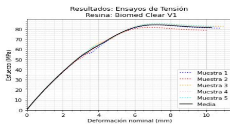
Figura 2. Curva esfuerzo-deformación de la resina Biomed Clear en tensión.
